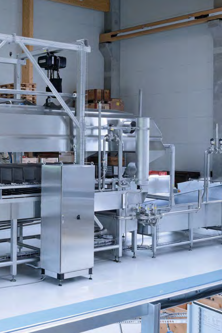
Impianto di cottura del tipo staedler CK1600, costruito dalla ditta staedler automation AG. Con questo impianto verranno cotti spaetzle in un bagno di acqua.
